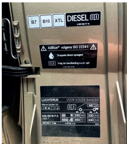
À l'intérieur du clapet du réservoir, si un autocollant mentionne «XTL», vous pouvez utiliser du HVO100.
