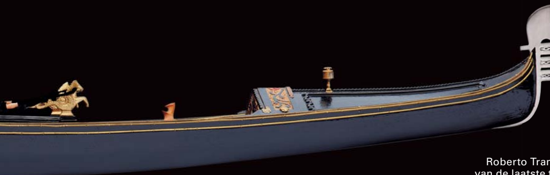
Acht houtsoorten en een asymmetrische constructie: dat zijn twee van de grote geheimen van het gondelbouwen.
